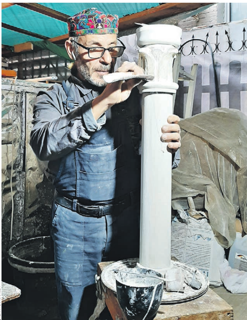
13 августа 2021 года. Реставратор Арман Симонян воссоздает балконные балясины и другие элементы декора в импровизированной мастерской на Садовой-Кудринской улице
