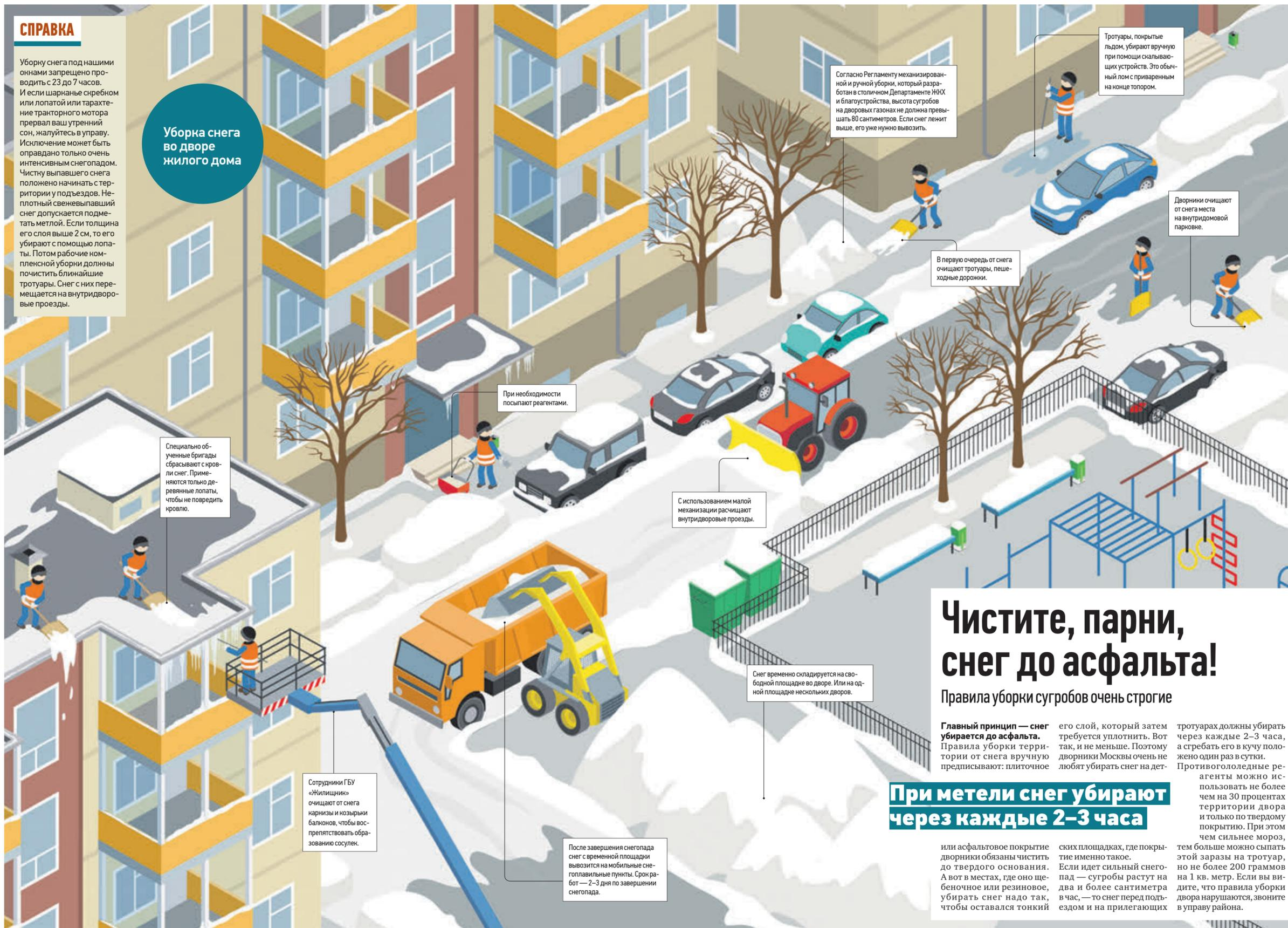
Специально обученные бригады сбрасывают с кровли снег. Применяются только деревянные лопаты, чтобы не повредить кровлю.
