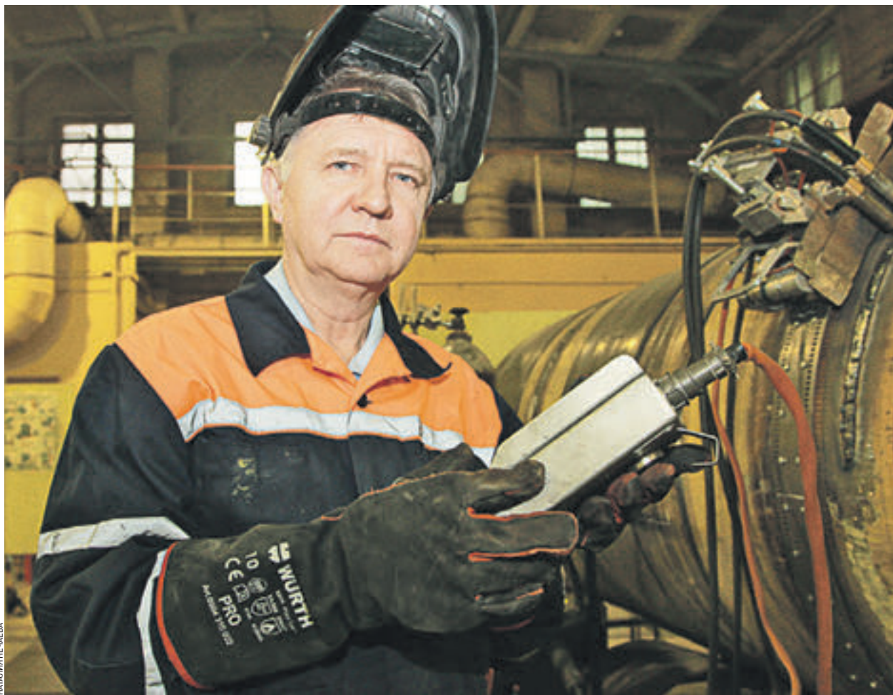
20 мая 2016 года. Главный сварщик Мосгаза Владимир Бродягин изобрел уникальный двухдуговой орбитальный сварочный аппарат, с помощью которого сварной шов удастся сделать всего за 40 минут. Сварщику на это требуется 5–6 часов
