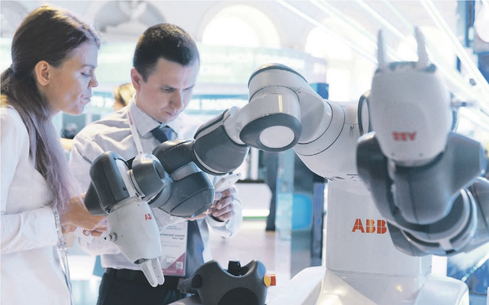
30 июня 2016 года. На Московском урбанистическом форуме компания АББ представила свою новейшую разработку — двурукого промышленного робота, предназначенного для совместной работы с человеком
