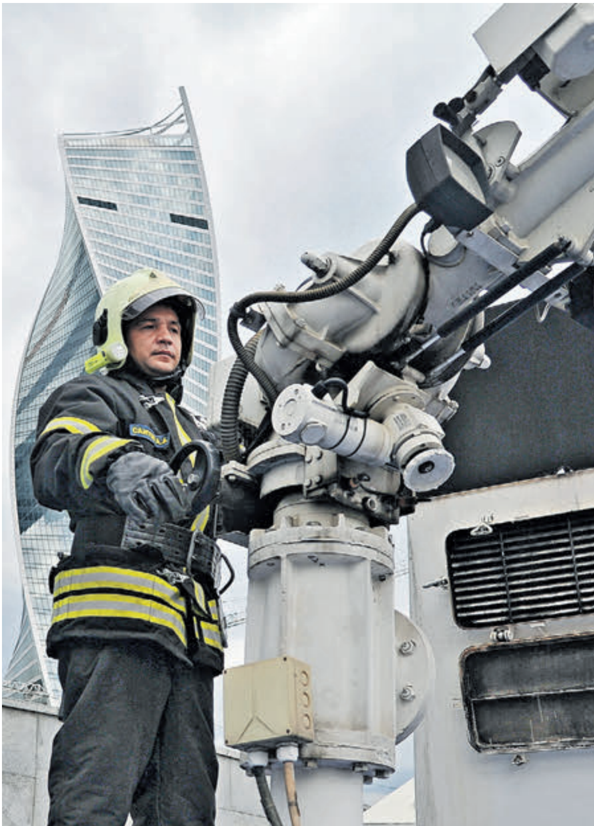
25 июля 2017 года. Пожарный отряда по тушению пожаров на водных объектах Альберт Сайтов за одним из лафетов системы водораспыления и водяных завес корабля «Полковник Чернышев» готов подключиться к тушению огня
